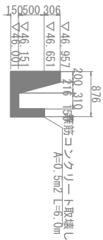
左岸 進入路部
