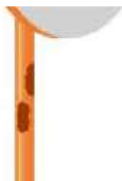
腐食等による穴、ヒビ、錆、折れや曲がりなど
