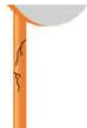
腐食等による穴、ヒビ、錆、折れや曲がりなど
